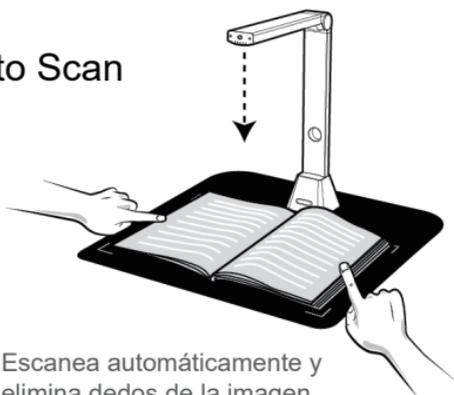
Escanea automáticamente y elimina dedos de la imagen escaneada.
